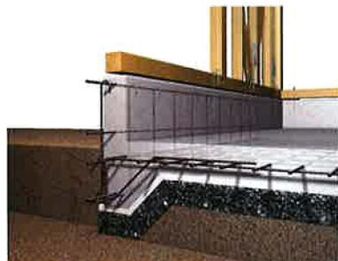
家づくりは、なんといっても家を建てる場所に合わせた基礎工事が重要。写真はテクノストラクチャー工法が行なっている、2階建ベタ基礎工事の仕様例。
