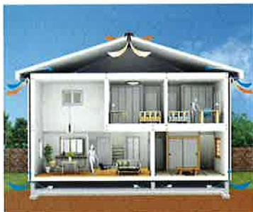
構造体や断熱材が痛まないように、常に床下から天まで新鮮な空気が通るようになっている。
