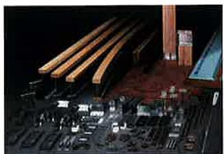
日本の住宅技術を徹底的に調べて導き出したのが、木と鉄の長所を併せ持つ家です。そのため、柱には圧縮強度の高い木材を用い、梁には曲げ強度の高い鉄骨を組み合わせるといった結論に至る。その結論から導き出した答えの一つが、テクノストラクチャー工法の代名詞ともいえるテクノビーム。これは梁の基本部分にH型の鋼材を採用し、その鋼材の上下を木で挟み込んだもの。これにより梁に上下から掛かる力に対して強固な耐久性を実現。木造住宅の弱点をカバーしている。さらに梁と柱の接合部分にも金属金具を使い、地震時における引っ張る力、押される力のどちらにも耐えられる高い強度を誇る。
